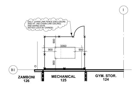
PARTIAL PLAN FOR CHAINLINK ENCLOSURE OUTSIDE OF MECHANICAL 125
