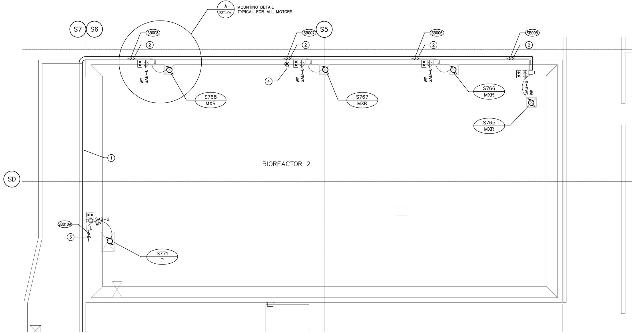
BIOREACTOR 2 — ROOF POWER PLAN
