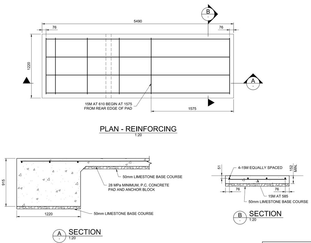
ALL CRASH CUSHION REINFORCING TO BE STAINLESS STEEL AS PER NOTE ON SHEET 001 REGARDING TRAFFIC BARRIER REINFORCING STEEL.
