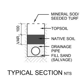
SUBSURFACE DRAINAGE SYSTEM
