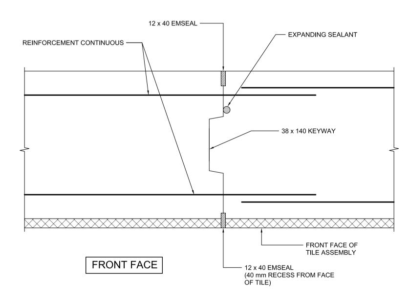
TYPICAL WALL JOINT DETAIL SCALE 1:5
