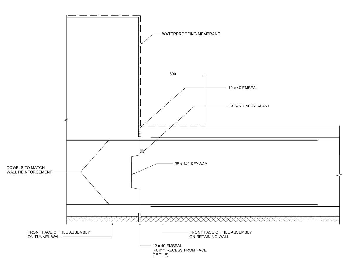
TYPICAL TUNNEL/WALL JOINT DETAIL SCALE 1:5
