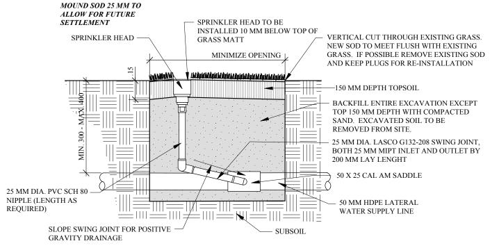
2 SPRINKLER HEAD/SWING JOINT SECTION
