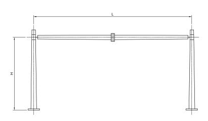
CANTILEVER STRUCTURE - STRAIGHT ARM (TYPE 1.1)
