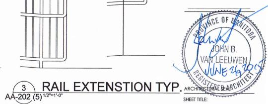
WRAP RAILING AROUND UPPER TO LOWER - EXTEND 1'-0" TYPICAL -
