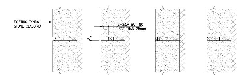
A) DETERIORATED B) MORTAR CUT BACK MORTAR JOINT TO SOUND SURFACE REPOINTING DETAILS
