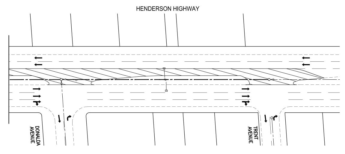
MAINTAIN A MINIMUM OF 2 LANES IN BOTH DIRECTIONS ALONG HENDERSON HWY. AT ALL TIMES. NO LEFT TURNS PERMITTED OFF HENDERSON HWY. ONTO SIDE STREETS WHILE LANES ARE CLOSED ON HENDERSON HWY. A MINIMUM OF 1.5m SIDEWALK WIDTH SHALL BE MAINTAINED FOR PEDESTRIAN TRAFFIC. NO COMPLETE CLOSURE OR BLOCKAGE OF ANY SIDEWALK SHALL BE PERMITTED AT ANY TIME.
