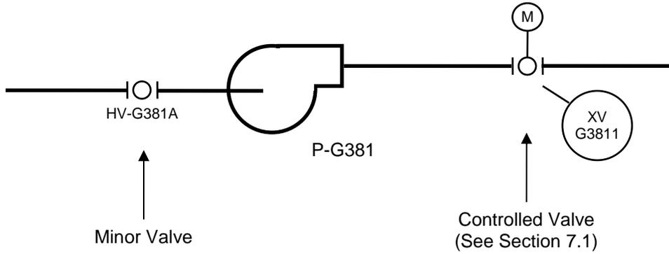
**Figure 5-1 : Valve Identification**
