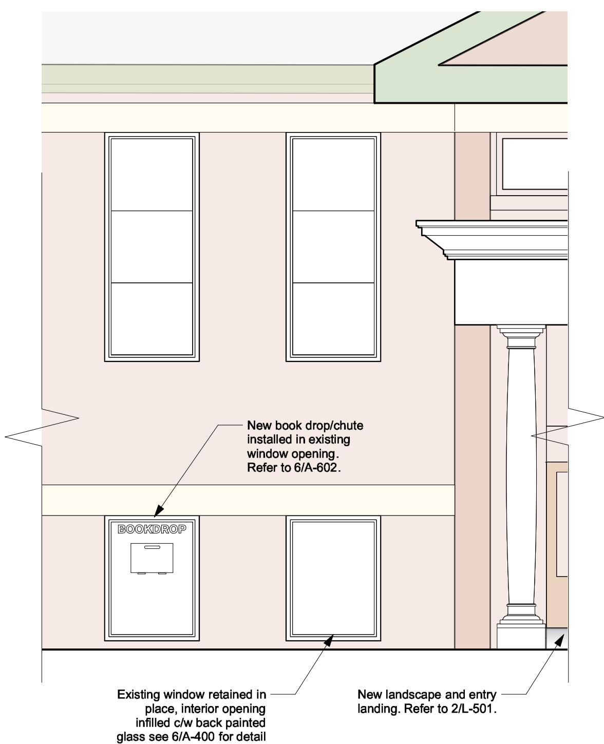
5 East Exterior Elevation Scale: 1:50 A-400
