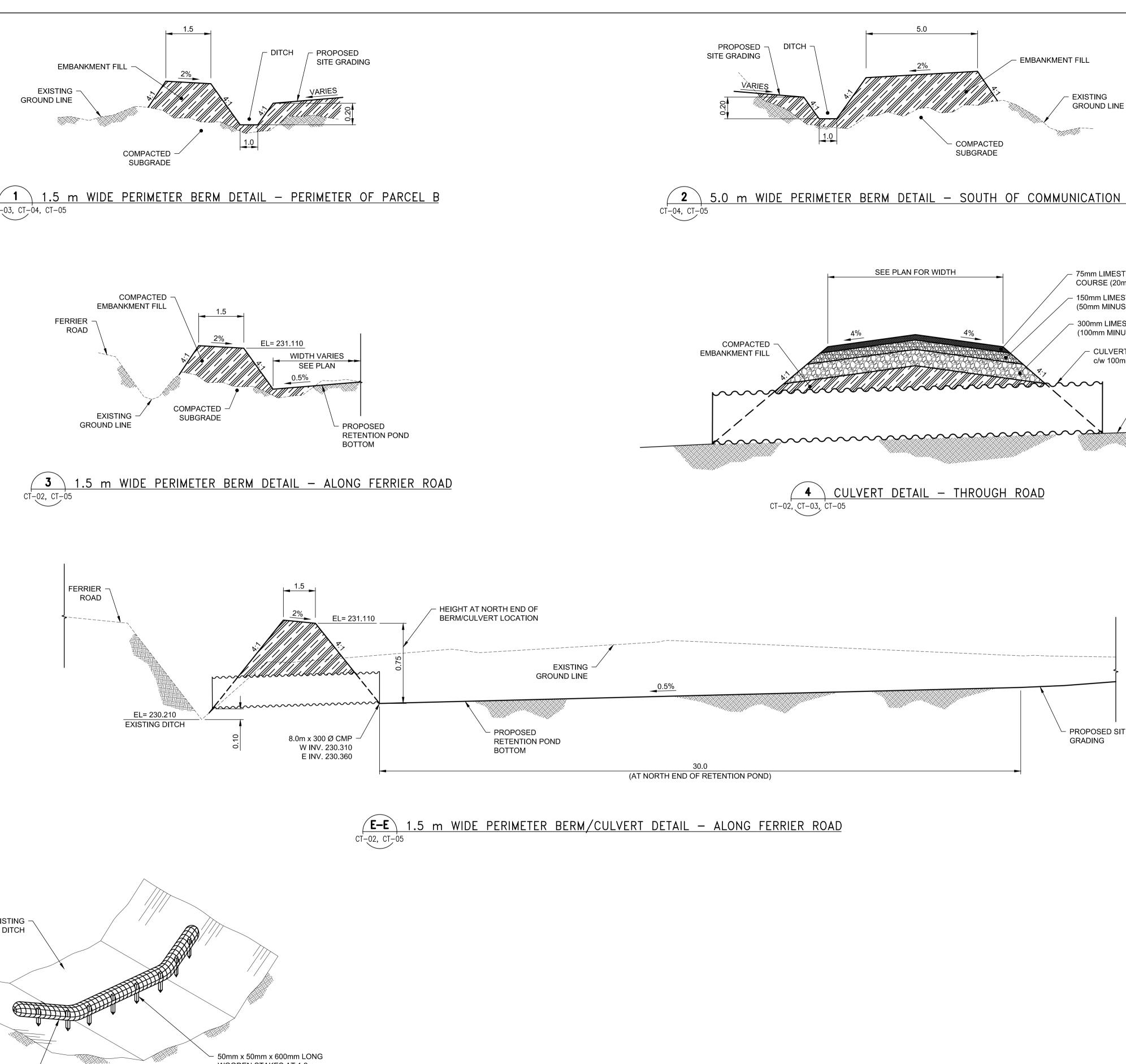
WOODEN STAKES AT 1.2m SPACING. DRIVE THROUGH NETTING ON DOWNSTREAM SIDE OF ROLL.
