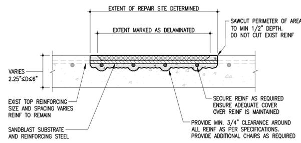
**1** TYPICAL TOP SURFACE REPAIR DETAIL
