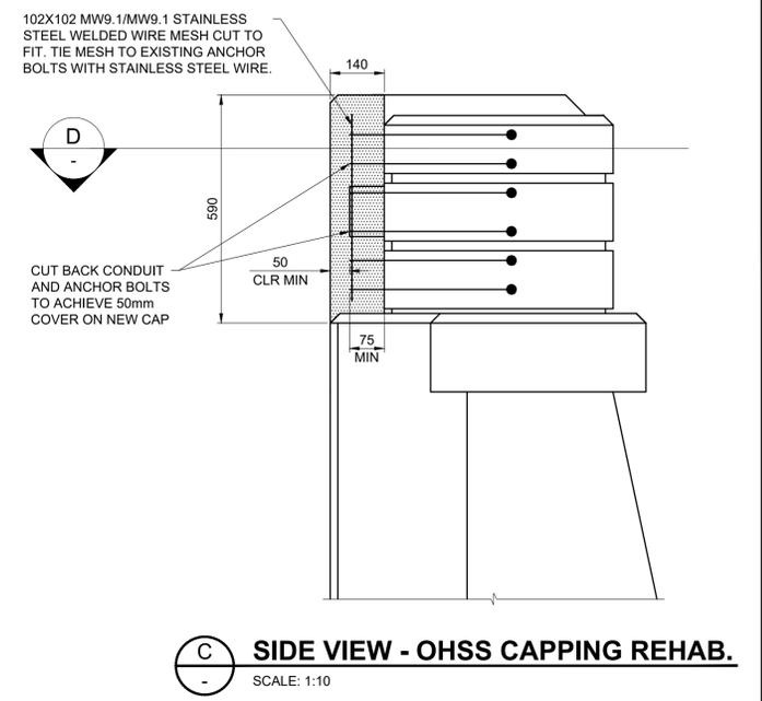
**C SIDE VIEW - OHSS CAPPING REHAB.**
