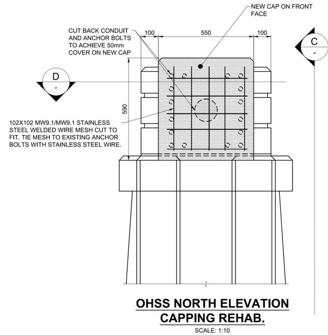
**OHSS NORTH ELEVATION CAPPING REHAB.**
