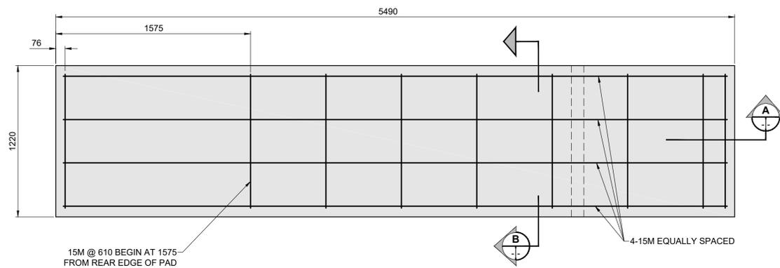
**QUADGUARD CONCRETE PAD - REINFORCING PLAN**
