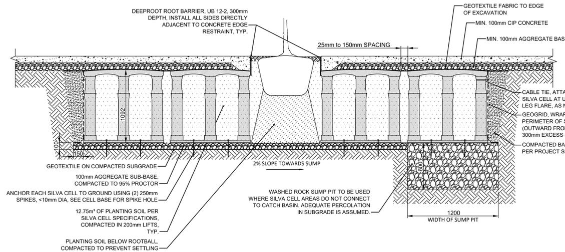
CONCRETE SIDEWALK OVER 3X SILVA CELL SYSTEM - WITH SUMP PIT
