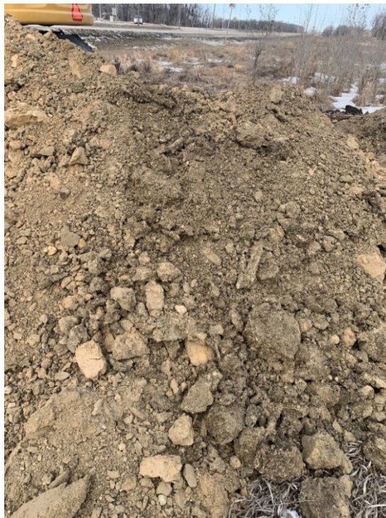
TP24-01 Photo 2: Clay -rich Silt Till
