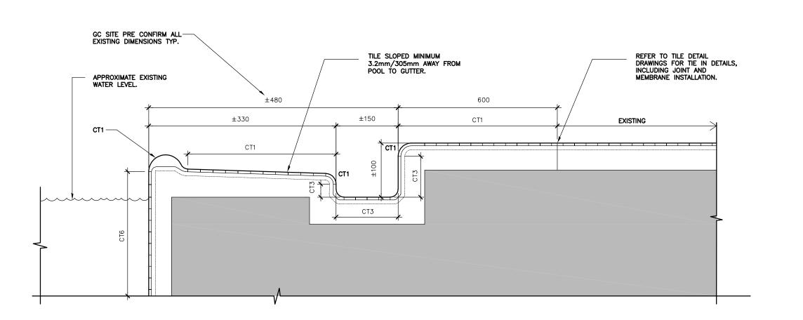
4 TYPICAL GUTTER DETAIL SCALE 1:5
