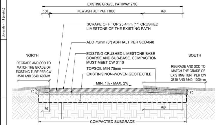
**ASPHALT PATH OVER EXISTING GRAVEL PATH**
