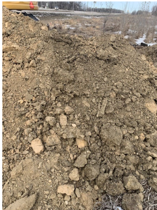
TP24-01 Photo 2: Clay -rich Silt Till
