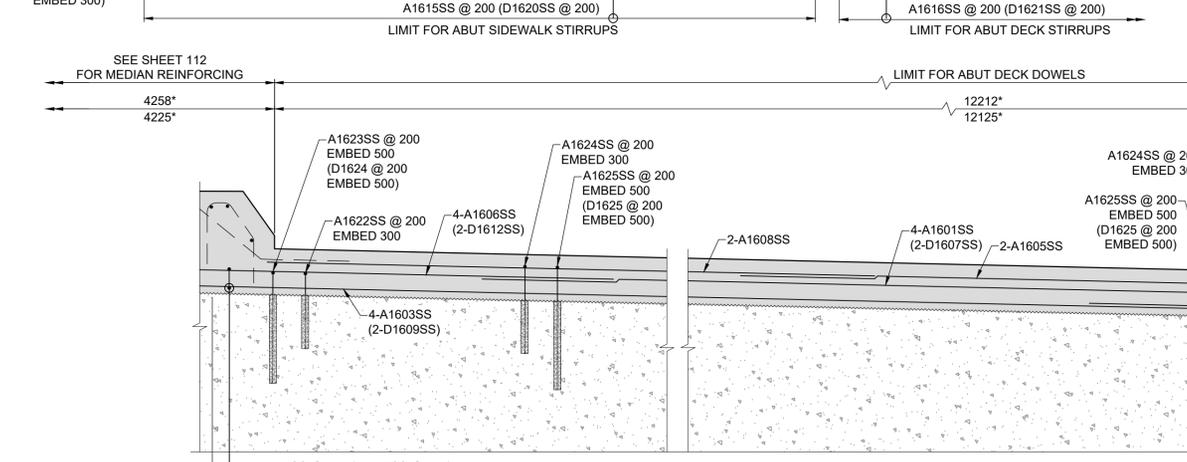
**CONCRETE OVERLAY - REINFORCING CON'T**
