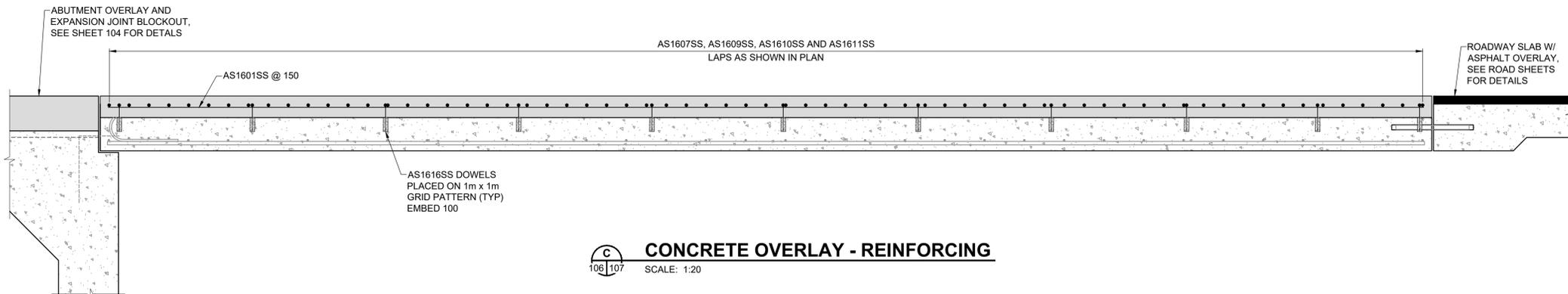
**C** CONCRETE OVERLAY - REINFORCING
