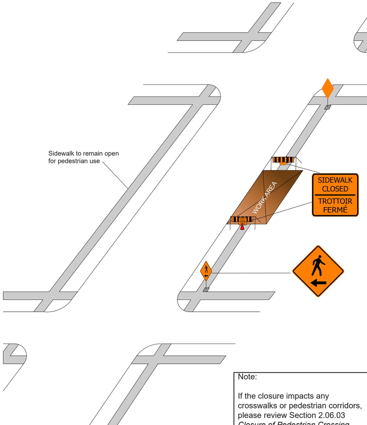
LONG TERM PARTIAL BLOCKAGE OF A SIDEWALK
